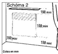
2.2 Le convecteur se fixe au mur à l'aide d'une platine murale livrée dans l'emballage. Pour fixer cette platine au mur, procéder de la manière suivante :
