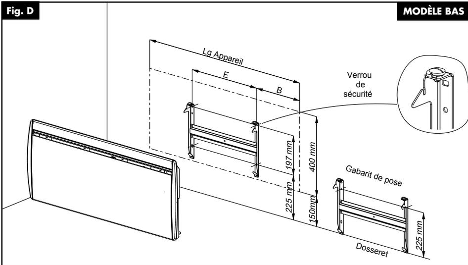
**Conseil :** Pour faciliter l'obtention de la cote minimale de 150mm (bas de l'appareil par rapport au sol), il suffit de placer le dossieret contre le mur, pattes inférieures posées au sol, pour avoir grâce aux repères de perçage, la fixation inférieure du dossieret.
