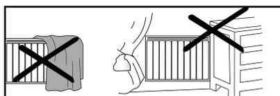
■ Si l'appareil est recouvert, il y a risque de surchauffe.
