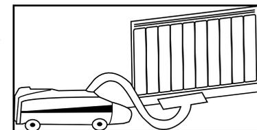
**NE JAMAIS UTILISER DE PRODUITS ABRASIFS OU À BASE D'ACÉTONE QUI RISQUERAIENT DE DÉTÉRIORER LE REVÊTEMENT EPOXY.**
