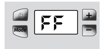
Pour supprimer le verrouillage du clavier, appuyez de nouveau pendant environ 3" sur les touches + et - pour annuler le verrouillage.
