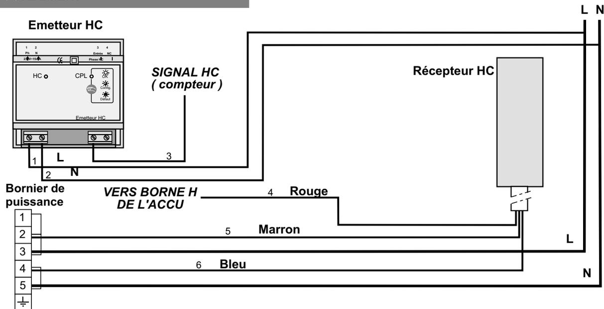
**ATTENTION :** Le fil rouge du récepteur doit être raccordé sur la borne H de l'accumulateur.
