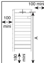
**La verticalité peut être vérifiée à l'aide d'un niveau à bulle ou d'un fil à plomb.**
