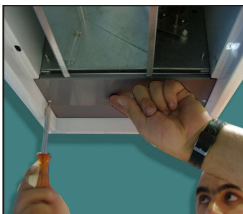
Remonter les 2 obturateurs à l'aide de 4 vis ( 2 vis par obturateur ).
