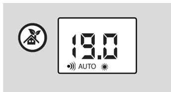
En cas d'absence prolongée, l'appareil diminue progressivement sa consigne de température. Lorsqu'il détecte une présence, il réagit et revient dans le mode de fonctionnement défini par l'utilisateur.
