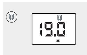
**i** Cette fonction coupe automatiquement l'appareil de chauffage en cas de détection d'une chute brutale de la température dans la pièce (Ex : une fenêtre ou une porte ouverte).
