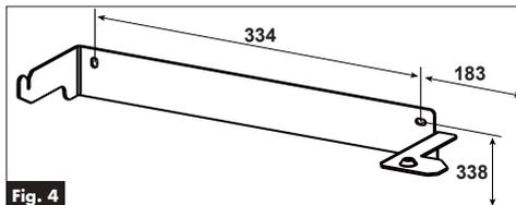
Montez la patte murale supérieure sur l'appareil et verrouillez-la en agissant à l'aide de la clé «torx T20» (jointe dans le carton) sur la vis dans le sens des aiguilles d'une montre (Rep.1 Fig.5)
