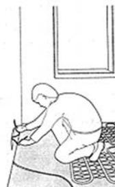
4 Raccordement des liaisons froides (sans tubage en position horizontale et première finition électrique des éléments chauffants).
