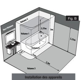
L'installation doit être conforme aux normes en vigueur dans le pays d'installation (NFC 15-100 pour la France).
